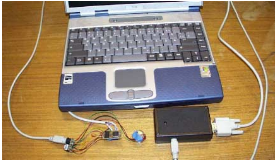
Abb.3: RS232-Interface, Mainboard und Akku mit Schnittstellenadapterbox
