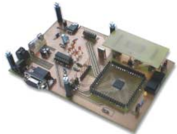
Abbildung 4: Hardware Emulator zur Unterstützung von Eigenentwicklungen
