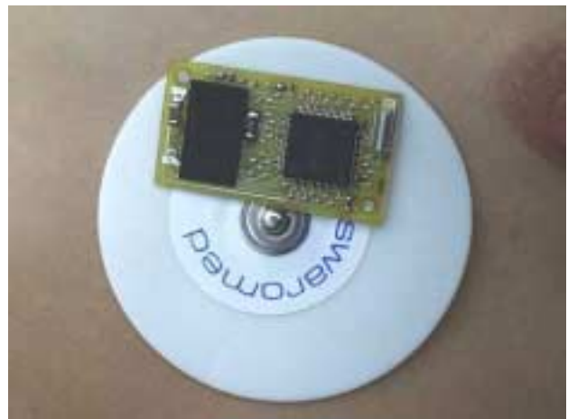
Abbildung 1: MicroMonitor MM3 in 1:1 Originalgröße auf Standard (55mm) EKG Elektrode
